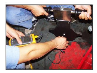
3. В такой ситуации, мы должны устранить отклонение температуры регулятора. (отклонение температуры составляет 24 градуса, т.е. 196 – 220 = -24).
