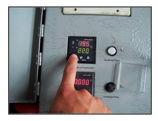
4. При стабильной температуре 220 градусов на дисплее, повторно проверьте температуру поверхности нагревательного элемента. Если все еще существует отклонение температуры, то повторите описанную выше операцию по корректировке температуры еще раз.
