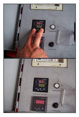
В. Нажмите кнопку "SET" дважды, на дисплее отобразится нижеследующий рисунок: Если начальная температура для корректировки составляет 5 градусов, то для корректировки температуры вводим нижеследующие данные:
