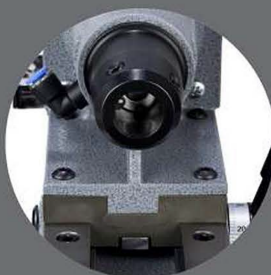
Монолитное исполнение корпуса и салазок
