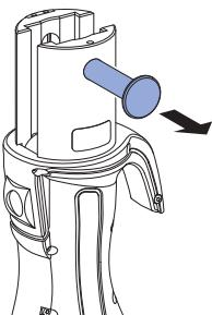
**3** 将挤压附件装入挤压器中。
