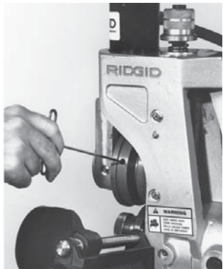
Рисунок 11 – Ослабление установочного винта в накаточном ролике
