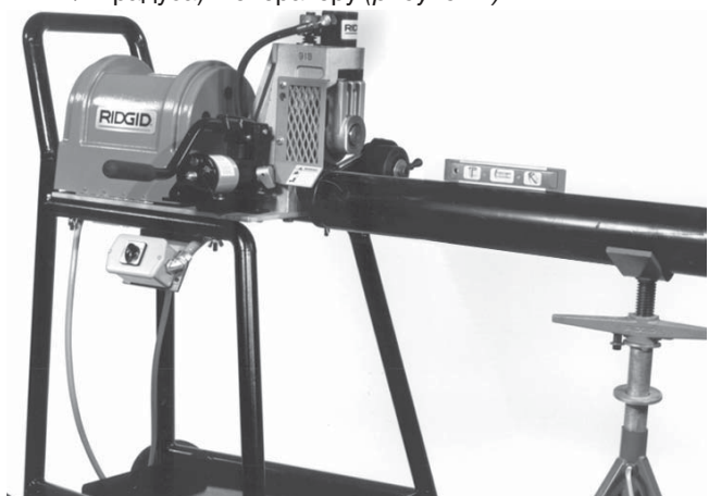
Рисунок 6 – Выравнивание трубы на трубной опоре и желобонакатчике 918-I
