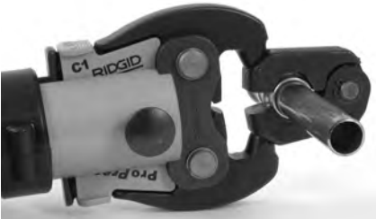
Kuva 10 – Toimilaitteen kiinnittäminen puristusrenkaaseen
