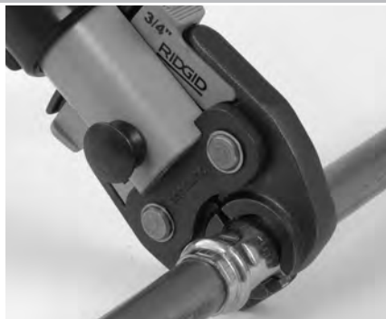
Рис. 7 – Установка пресс-клещей ножничного типа вокруг фитинга
