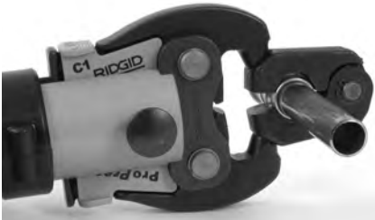
Рис. 10 – Крепление рабочей насадки на обжимном кольце
