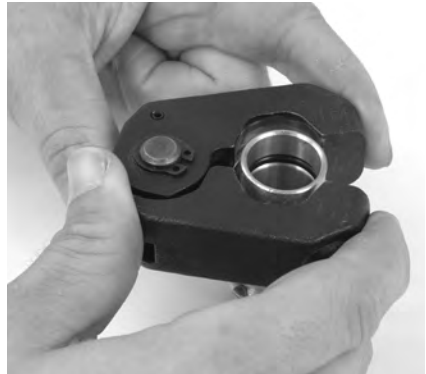
Figur 9 – Installere pressringen på utstyret
