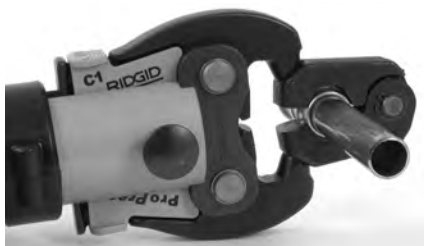
Obrázek 10 – Připojení pohonu k lisovacímu kroužku
