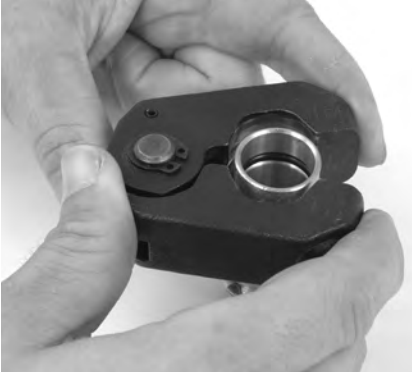
Kuva 9 – Puristusrenkaan asentaminen liittimeen
