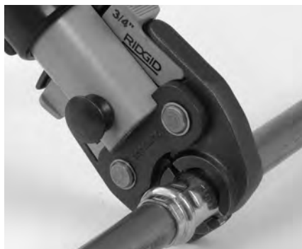
Figur 7 – Placera käftar av saxstil runt beslaget
