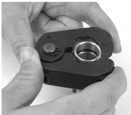
Rysunek 9 - Montaż pierścienia zaciskowego na okuciu
