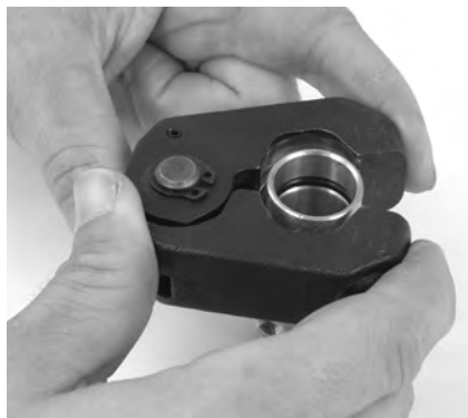
Figura 9 – Montarea inelului de presare pe fitting
