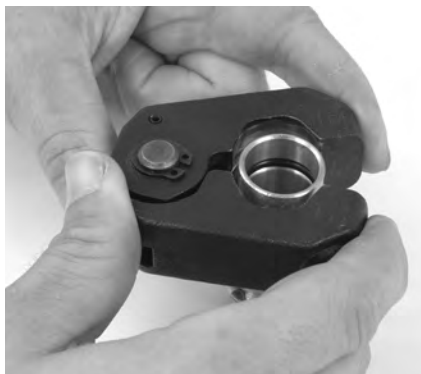
Figura 9 – Instalar o anel de prensagem no engaste
