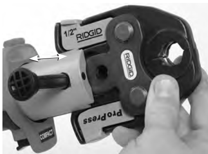
Slika 6 – Klin za montažu nastavka
