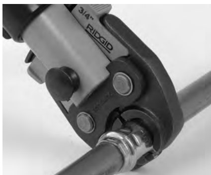
7-сурет – Қайшы тәрізді қармауыштарды фитинг айналасына орналастыру
