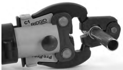
Figur 10 – Fastgørelse af aktuator på pressering
