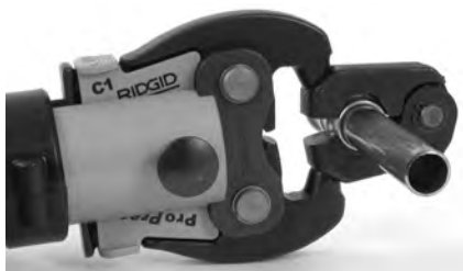
Figuur 10 – Aanbrengen van de actuator op de persring
