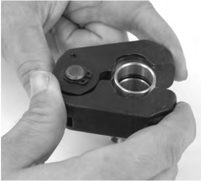
Рис. 9 – Установка обжимного кольца на фитинг
