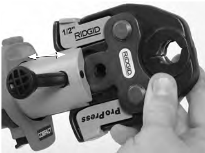
Рис. 6 – Штифт крепления насадки
