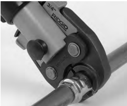
Figura 7 – Așezarea fălcilor tip foarfece în jurul fittingului
