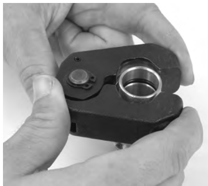
Slika 9 - Nameščanje obroča za stiskanje na nastavek
