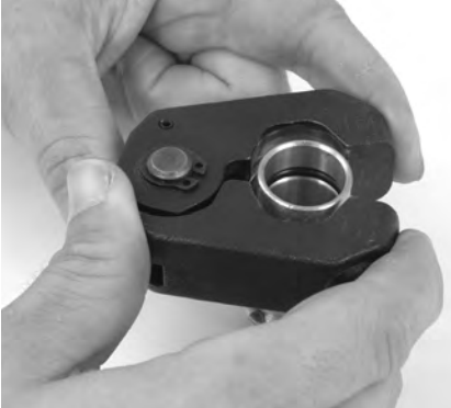
Slika 9 – Montaža prstena za prešanje na priključak
