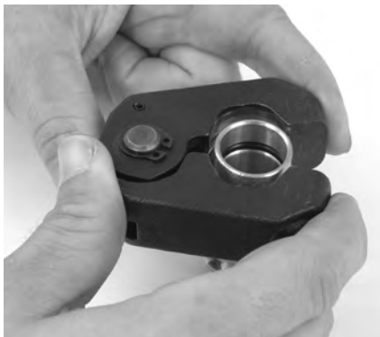
9. ábra - Présgyűrű elhelyezése a csőcsatlakozón
