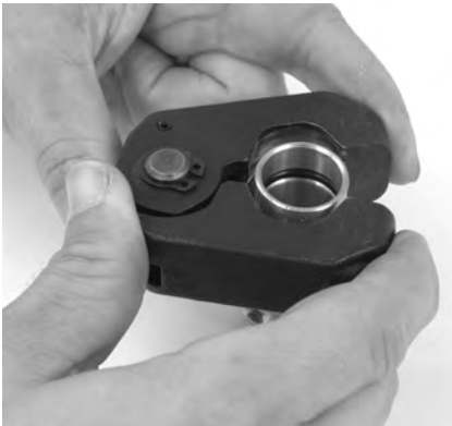
Figura 9 – Montaje del aro sellador en el acoplamiento
