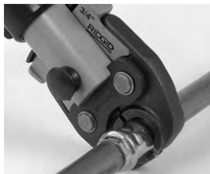
Obrázok 7 – Umiestnenie nožnicových čelustí okolo tvarovky
