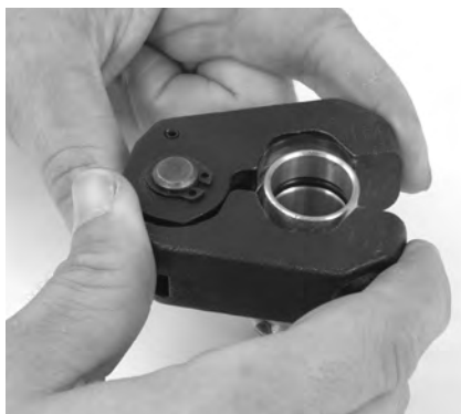
Obrázek 9 – Instalace lisovacího kroužku na armaturu
