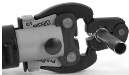
Εικόνα 10 – Σύνδεση ενεργοποιητή στον δακτύλιο πρεσαριστής σύνδεσης
