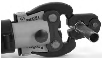
Rysunek 10 - Dołączanie siłownika do pierścienia zaciskowego
