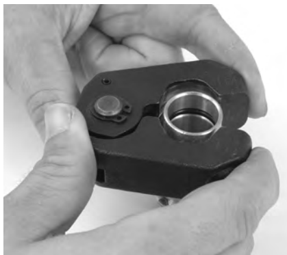
Figur 9 – Påsætning af pressering på fitting
