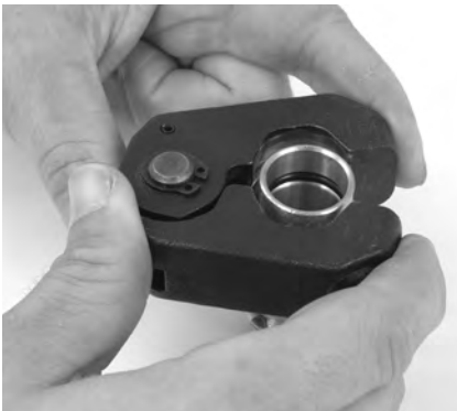
Abbildung 9 – Anbringen des Pressrings am Fitting
