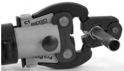
10. ábra - Működtető elem rögzítése a présgyűrűn
