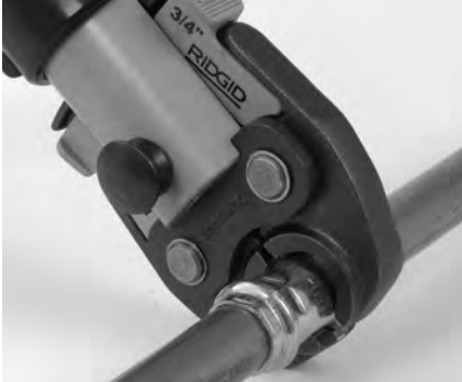
Figura 7 – Colocar os mordentes estilo tesoura à volta do engaste
