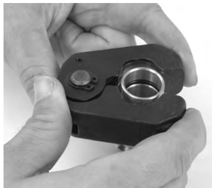
Obrázok 9 – Inštalácia lisovacieho krúžka na tvarovku
