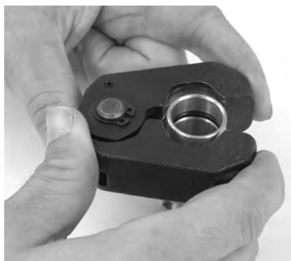
Εικόνα 9 – Τοποθέτηση δακτυλίου πρεσαριστής σύνδεσης στον σύνδεσμο
