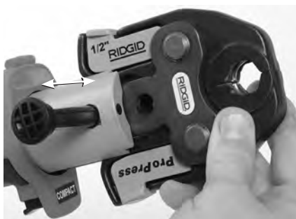
Figur 6 – Monteringstap til tilbehør
