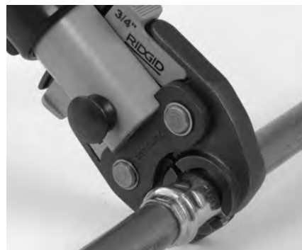
Slika 7 - Nameščanje škarjastih čeljusti okoli nastavka
