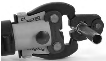
Slika 10 – Postavljanje aktuatora na prstenastu presu
