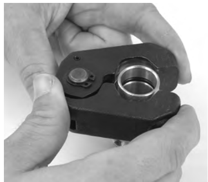
Slika 9 – Postavljanje prstenaste prese oko priključka
