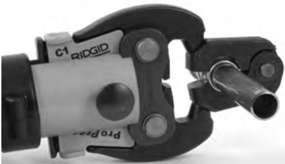
Abbildung 10 – Ansetzen der Ringbacke am Pressring
