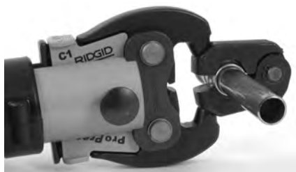
Obrázok 10 – Pripojenie akčného člena k lisovaciemu krúžku
