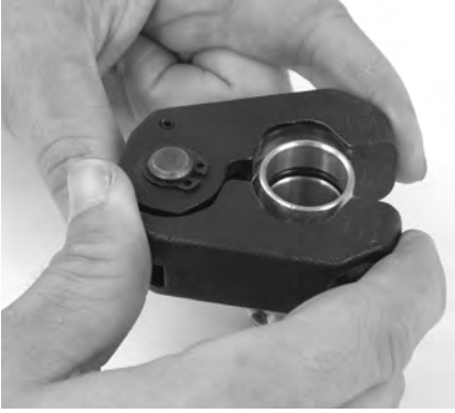
Şekil 9 – Pres Halkasının Tespit Elemanı Üzerine Takılması
