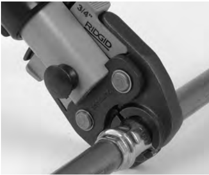
Figuur 7 – Aanbrengen van schaarbekken rond fitting
