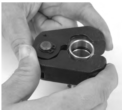
Figura 9 - Installazione dell'anello di pressatura sul raccordo
