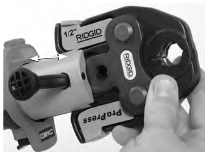
Figura 6 – Știft montaj atașament
