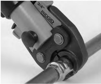
Kuva 7 – Saksityyppisten leukojen asettaminen liittimen ympärille
