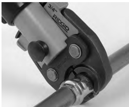
Obrázek 7 – Umístění nůžkových čelistí kolem armatury
