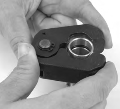
Figur 9 – Sätta dit pressringen på beslaget
