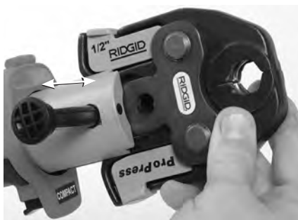
Figur 6 – Monteringspinne for tilbehør
