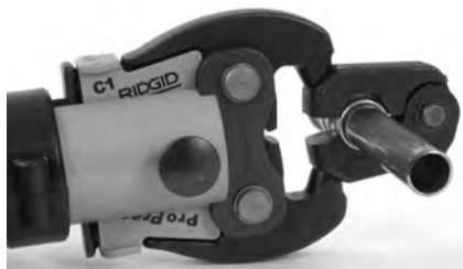
Figura 10 – Atașarea actuatorului la inelul de presare
