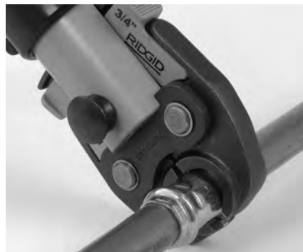
Slika 7 – Postavljanje makazastih čeljusti oko priključka
