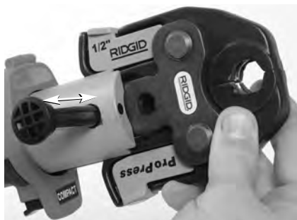
Figure 6 – Broche de retenue de tête
