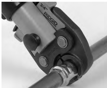
Rysunek 7 – Umieszczanie szczęk nożycowych wokół okucia
