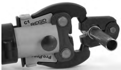
Figura 10 - Aggancio dell'attuatore all'anello di pressatura
